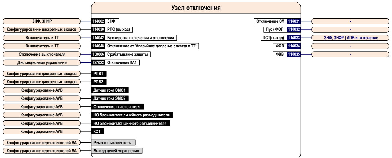
Рисунок 29.1 – Блок – схема узла отключения
